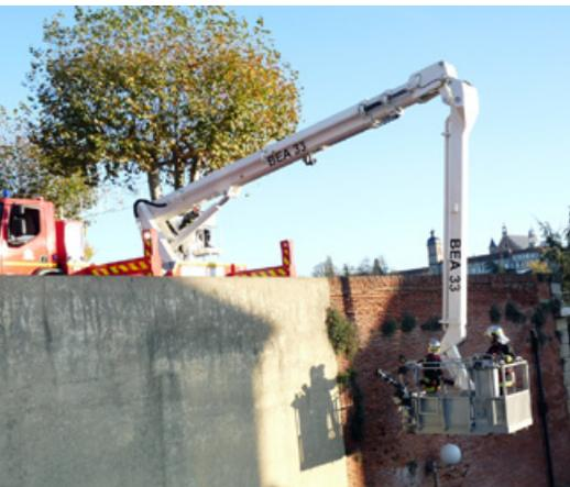
Autres gros avantages du BEA, sa capacité à travailler en négatif, derrière un obstacle grâce au bras pendulaire, et la colonne sèche qui évite l'établissement de lances et la manipulation de tuyaux au sommet de la nacelle.
